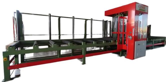
Il taglio si sviluppa con una barra corredata di catena guidata appositamente in testa per assicurare la massima precisione; la barra portacatena è idonea al taglio di pacchi con dimensioni mm. 1200 x 1200. La lubrificazione della catena viene garantita in modo automatico da una pompa ad ingranaggi. La velocità operativa e la facilità d'uso rendono la tagliapacchi automatica TPA uno strumento di lavoro importante e sempre più necessario nell'industria dell'imballaggio in legno.
